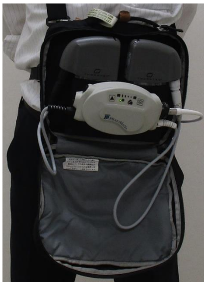
1. VAD (HeartMate II) 装着中の状態 バッグの中にシステムコントローラーとバッテリーが納められ、体内ポンプとは経皮ドライブラインで接続されている
