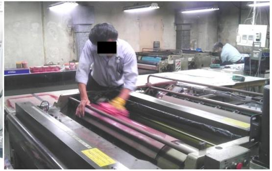
図2 印刷機の洗浄作業
