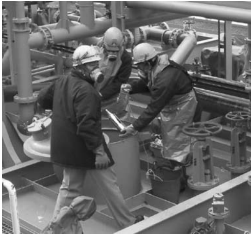
図 補-27. ETBE のサンプリング作業（屋外，船上）
