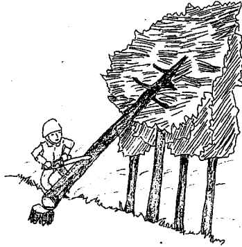
図5 かかっている木の元玉切り
